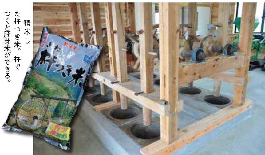
精米所に移設された杵つき施設。動力はモーターだが、基本的には水車小屋での作業と同じ。失われようとしている技術の伝承も意図している。
